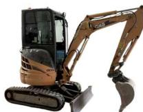
Máquina retroexcavadora, marca Case modelo CX30. Precio estimado:
